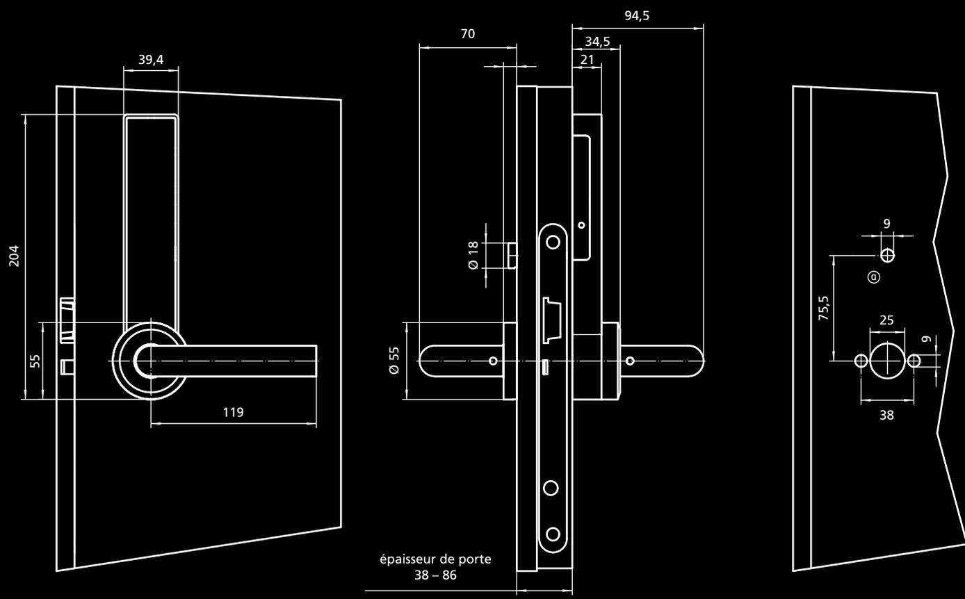
Version standard du système de fermeture de portes
